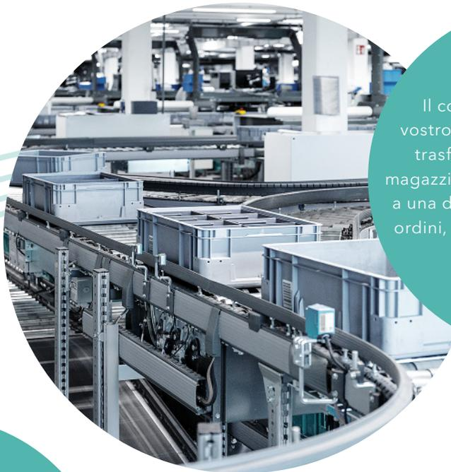
Il contenitore in cui si trova il vostro attrezzo di staffaggio viene trasferito automaticamente dal magazzino tramite ascensori e rulliere a una delle sette stazioni di prelievo ordini, dove vengono elaborati sino a 1.500 ordini all'ora.
